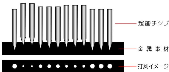
また、メタルプリントは、白い素材に黒いインクを乗せていくというよりも、映り込みや金属が持つ深み=濃いベースに打刻によって白いインクを乗せていくという感覚です。濃淡は印刷のように間引いたり薄く塗布するのではなく、打刻する深さによって穴の大きさを加減して表現します。
